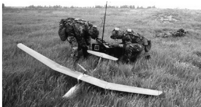
圖5FQM-151A 單兵攜帶式無人飛行載具[12]
